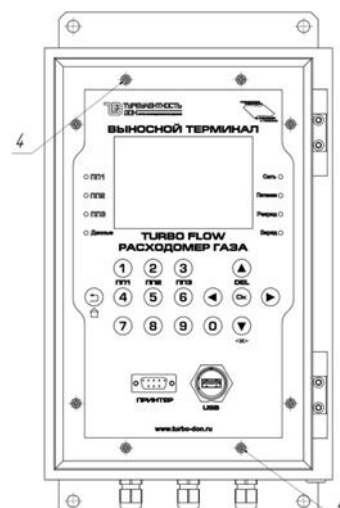
Рисунок 20 – Выносной терминал в металлическом корпусе (ВТМ)
