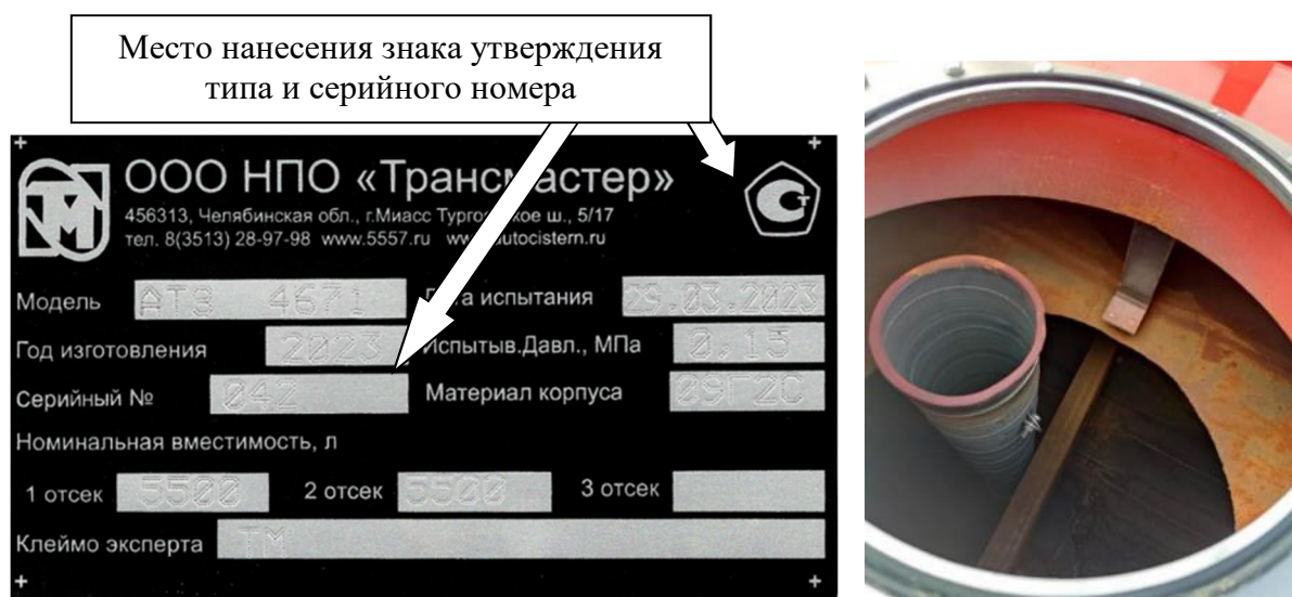
Рисунок 6 – Маркировочная табличка, указатель уровня налива (мерный угольник)
