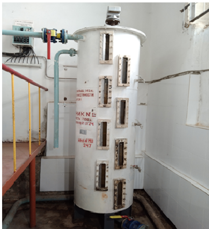
Рисунок 3 – Общий вид мерника МТВ-1, зав. № 5
