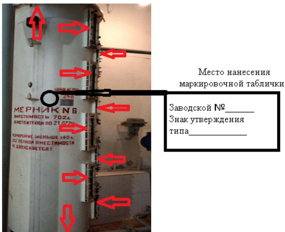
Рисунок 6 – Схема пломбировки мерника МТВ-1 зав. № 6 от несанкционированного доступа, обозначение места нанесения знака поверки, заводского номера и знака утверждения типа
