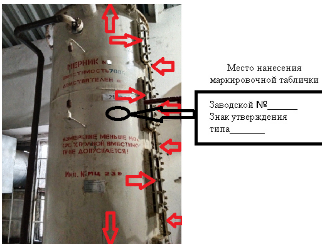
Рисунок 14 – Схема пломбировки мерника МТВ-1 зав. № 31 от несанкционированного доступа, обозначение места нанесения знака поверки, заводского номера и знака утверждения типа
