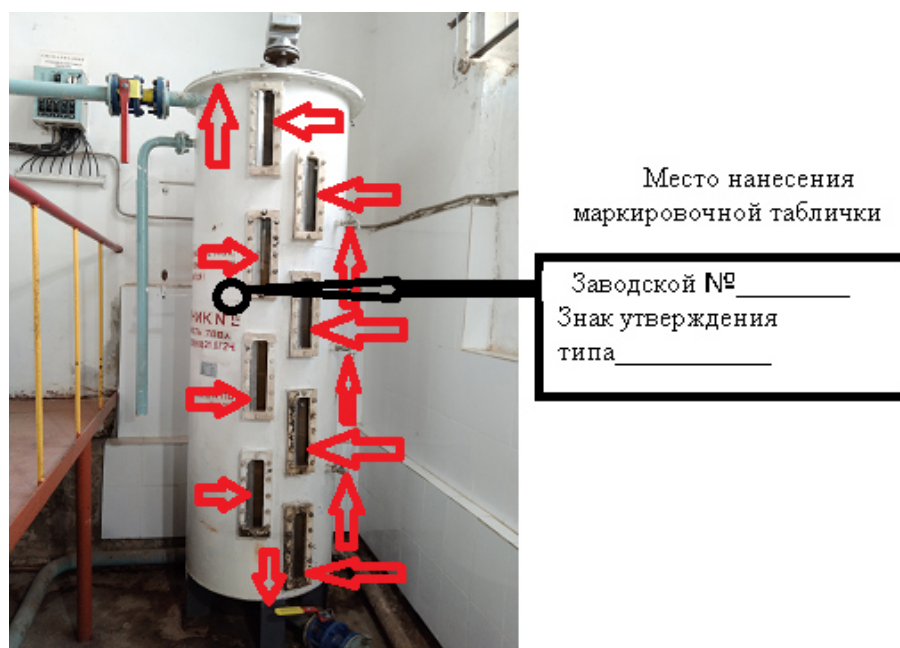
Рисунок 3 – Общий вид мерника МТВ-1, зав. № 5
