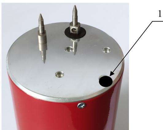
Рисунок 3 – Схема пломбировки мер из набора LQ-2408 от несанкционированного доступа и расположение места нанесения знака поверки: 1 – место нанесения знака поверки (мера LQ-2408-3 пломбируется со снятой подставкой).
