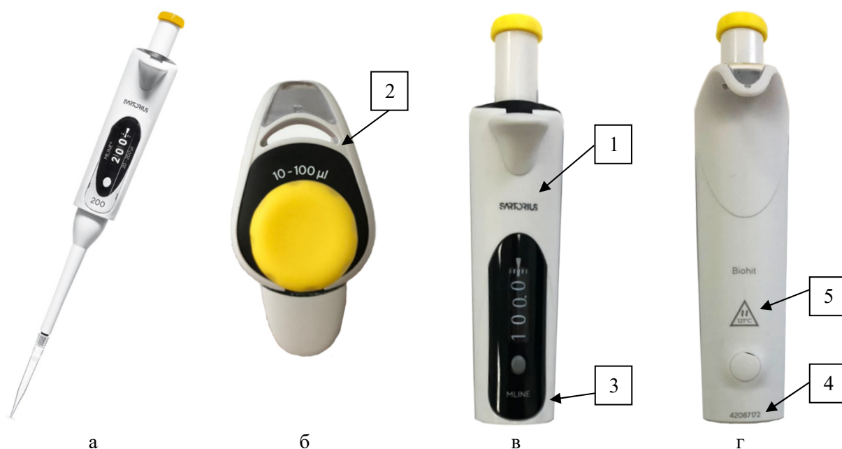
а – общий вид; б – вид сверху; в – лицевая сторона дозатора; г – задняя сторона дозатора.
