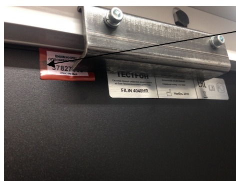
Рисунок 4 - Схема пломбировки от несанкционированного доступа
