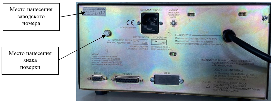
Рисунок 4 – Схема пломбировки приборов от несанкционированного доступа, обозначение места нанесения заводского номера измерителя HA1600
