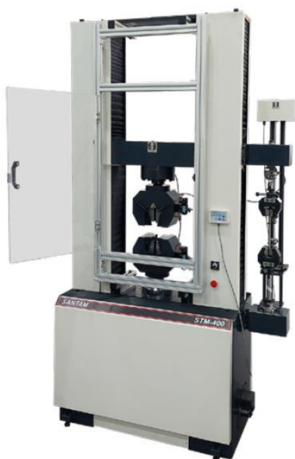
Рисунок 9 – Общий вид машин модификации STM-400B с дополнительной боковой зоной испытаний (боковой траверсой)
