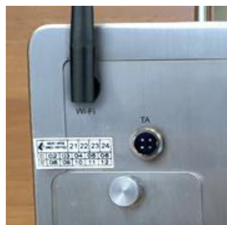
б) место пломбировки счётчиков портативного исполнения
