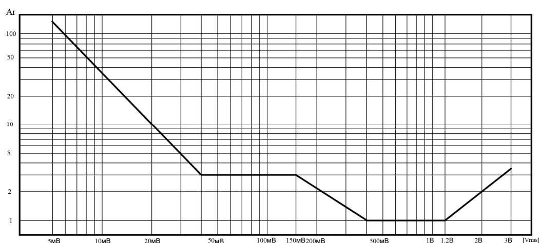
Рисунок 3 – Поправочный коэффициент A_r по уровню тест-сигнала (напряжению)
