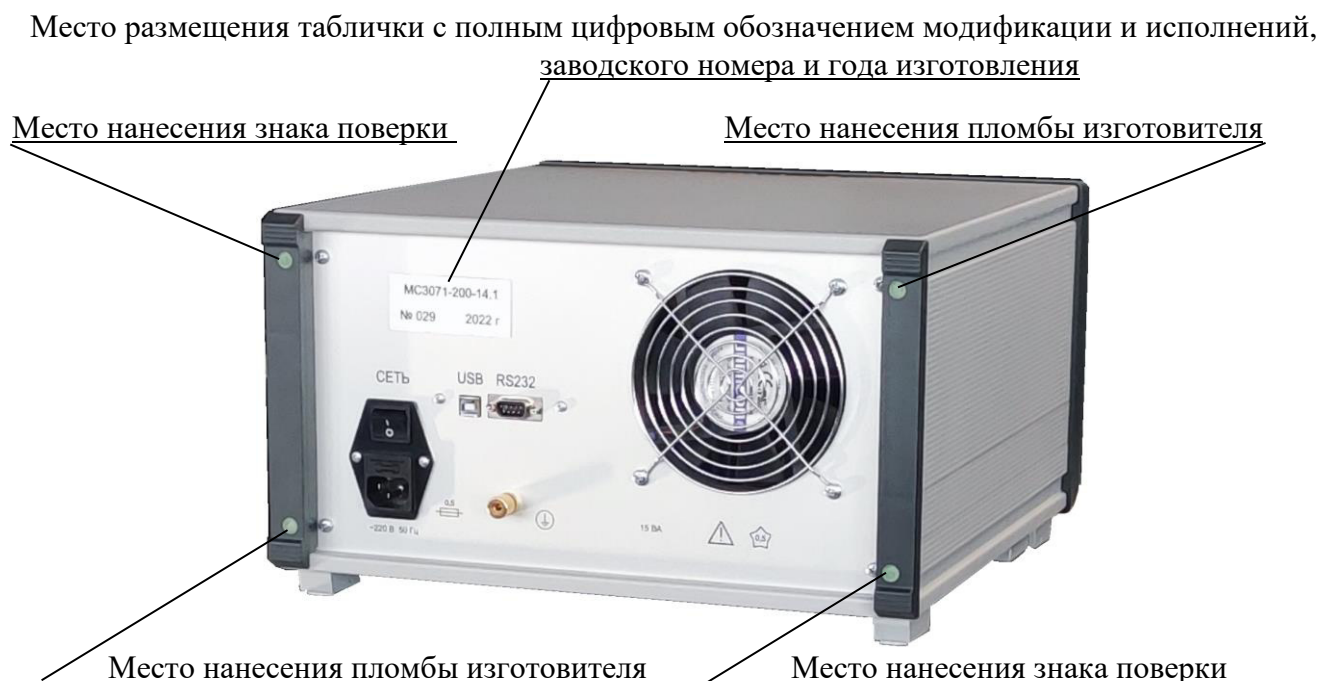
Рисунок 2 – Схема пломбировки от несанкционированного доступа, обозначение мест нанесения знаков поверки, полного обозначения кода модификации и исполнений, заводского номера и года изготовления ММЭС
