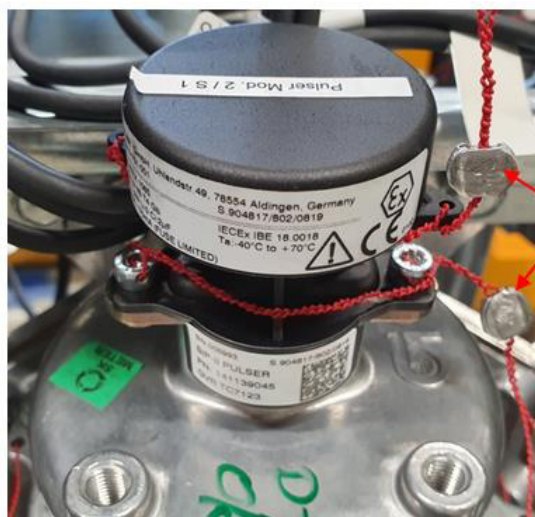
е) Схема пломбировки датчика импульсов SIP-II
