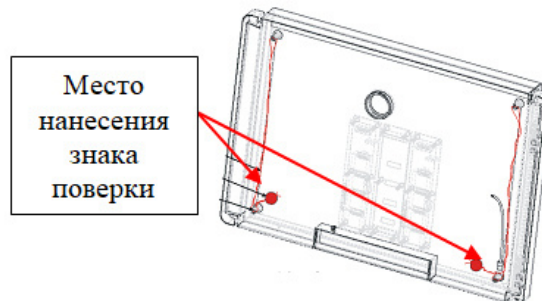
в) Схема пломбировки дисплея указателя суммарного учёта, изображенного на рисунке 2б (при наличии)
