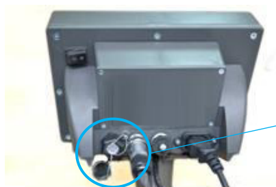
Рисунок 7 – Схема пломбировки от несанкционированного доступа весов с применением приборов весоизмерительных ТИТАН.
