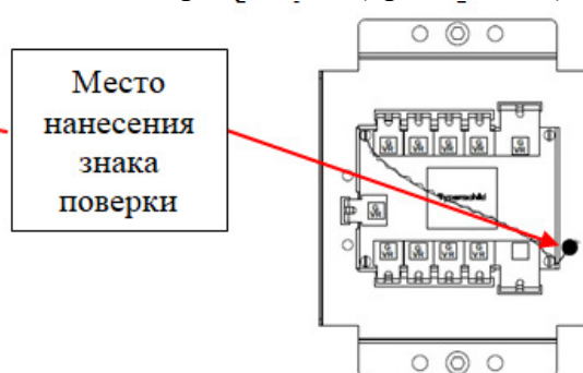
д) Схема пломбировки платы для подключения датчика импульсов (при наличии)
