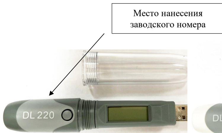
Рисунок 7 – Общий вид логгеров данных MerMax DL модели DL 220
