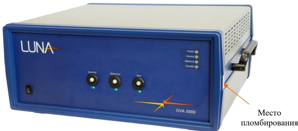
Рисунок 1 – Общий вид анализатора и схема пломбировки от несанкционированного доступа
