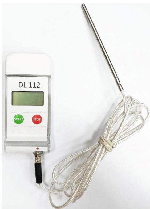
Рисунок 5 – Общий вид логгеров данных MerMax DL модели DL 112
