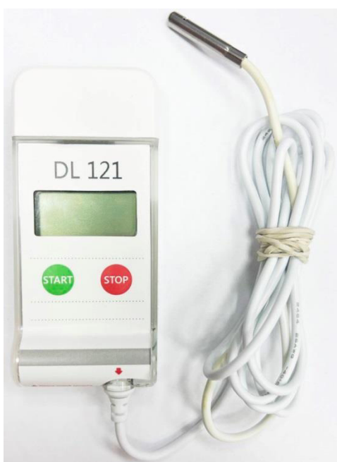
Рисунок 4 – Общий вид логгеров данных MerMax DL модели DL 121
