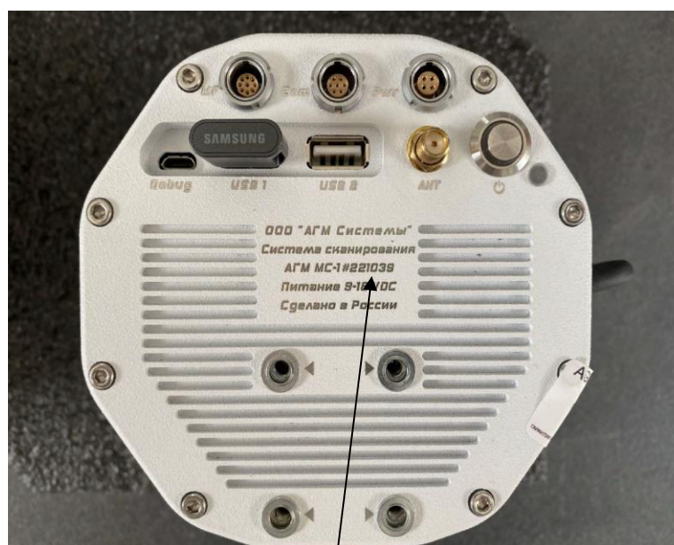
Рисунок 2 – Общий вид сканирующего блока со стороны боковой панели с указанием места нанесения знака утверждения типа
