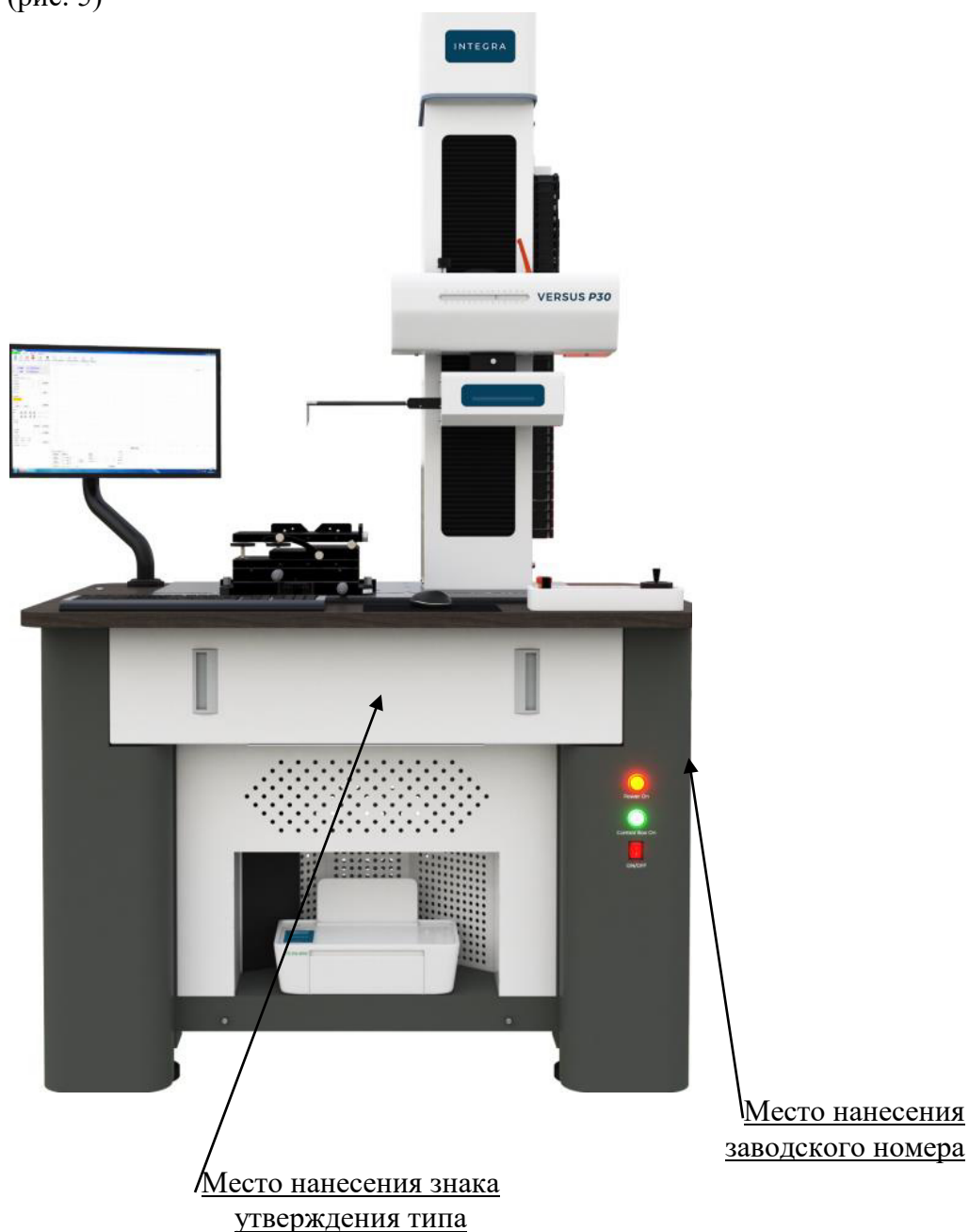
Рисунок 1 – Общий вид приборов для измерений параметров контура поверхности Integra Versus P10, Integra Versus P20, Integra Versus P30
