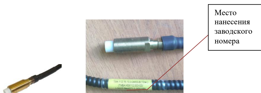
Рисунок 5 – Преобразователи модели ТМК-172-х и место нанесения заводского номера
