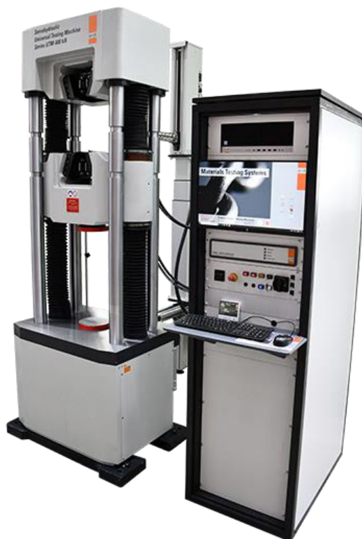
Рисунок 1 – Общий вид машин испытательных универсальных UTM
