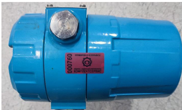
Рисунок 3 – Схема пломбирования датчиков от несанкционированного доступа
