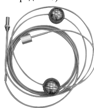
Рисунок 5 – Общий вид измерительных элементов (волноводов) ЭЛЕМЕР-УПМ-51
