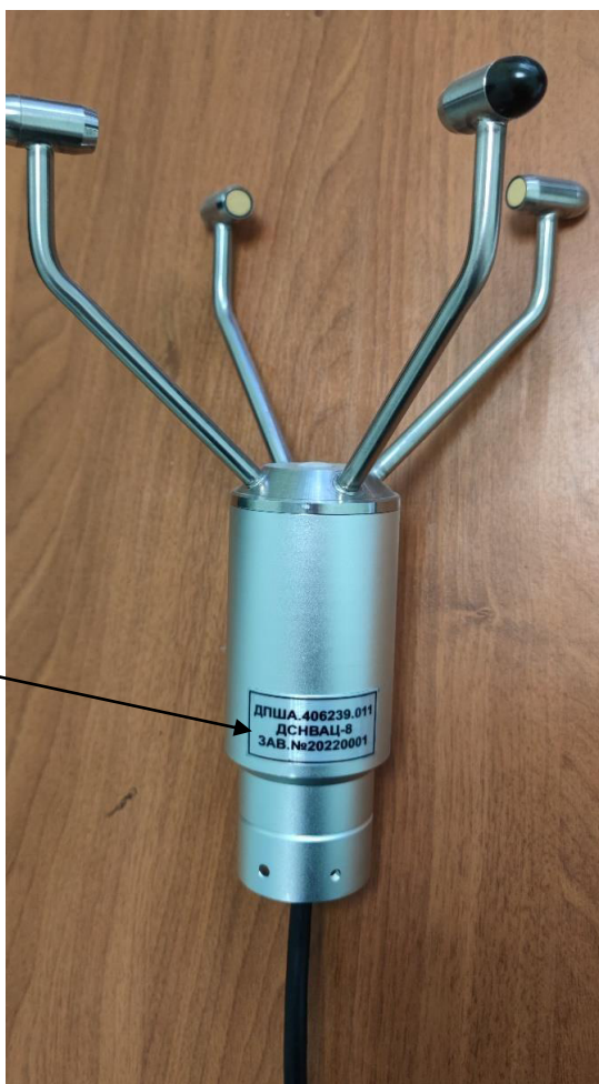
Рисунок 1 – Общий вид датчиков ДСНВАЦ-8 с указанием мест нанесения заводского номера и знака утверждения типа
