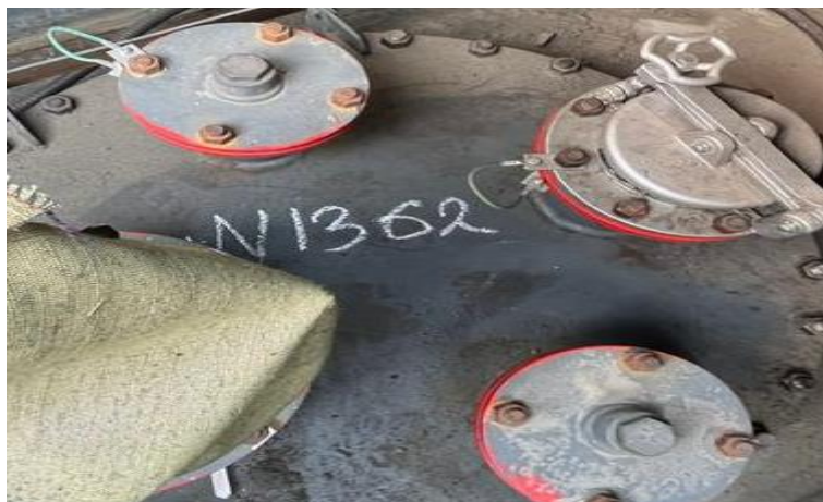
Рисунок 4 – Фотография горловины и заводского номера резервуара стального горизонтального цилиндрического РГС, модификации РГС-63 с зав. №1362
