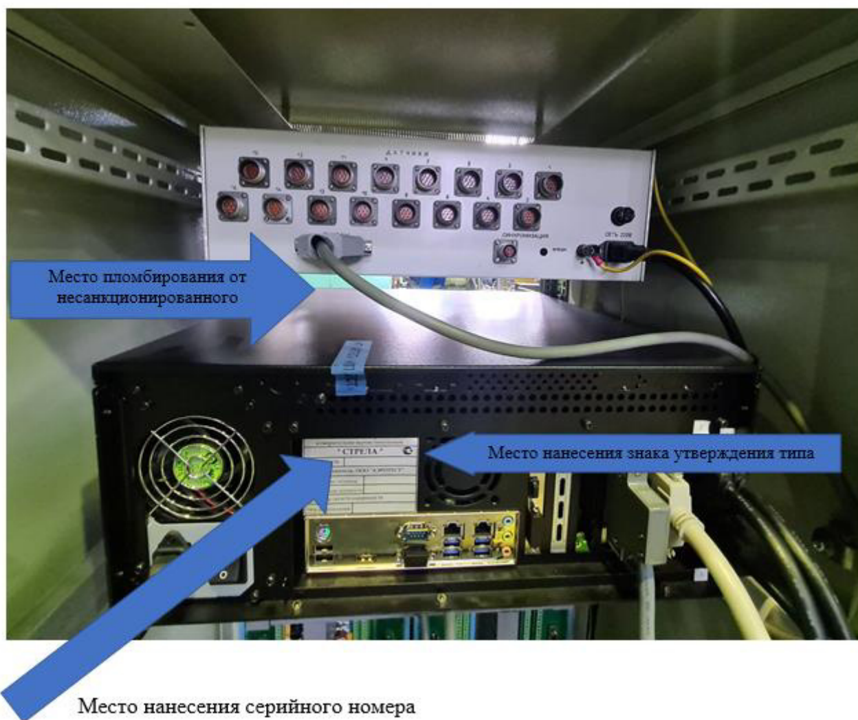
Рисунок 2 – Схема пломбировки от несанкционированного доступа
