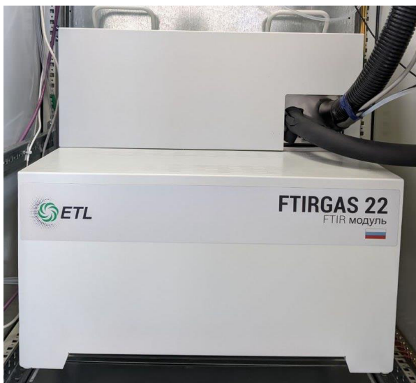
Рисунок 1 - Общий вид газоанализатора многокомпонентного FTIRGAS 22 модификации FTIRGAS 22 M-1 (допускается расположение фитингов подключения газовых линий на верхней панели измерительного модуля)
