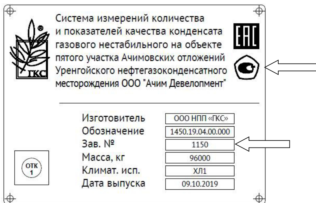
Рисунок 1 – Обозначения мест нанесения знака утверждения типа и заводского номера СИКГК
