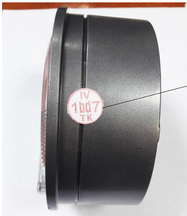
Рисунок 3 - Схема пломбировки манометров
