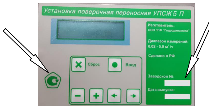
Рисунок 3 – Обозначения мест нанесения знака утверждения типа и заводского номера
