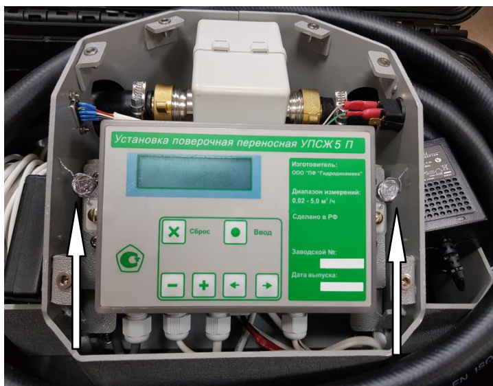
Рисунок 2 – Схема пломбировки от несанкционированного доступа, обозначение места нанесения знака поверки установок поверочных переносных УПСЖ 5П
