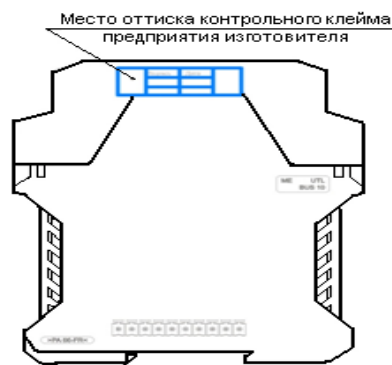
Рисунок 3 – Схема пломбирования блока БПР-КДМ, входящего в состав СДУ
