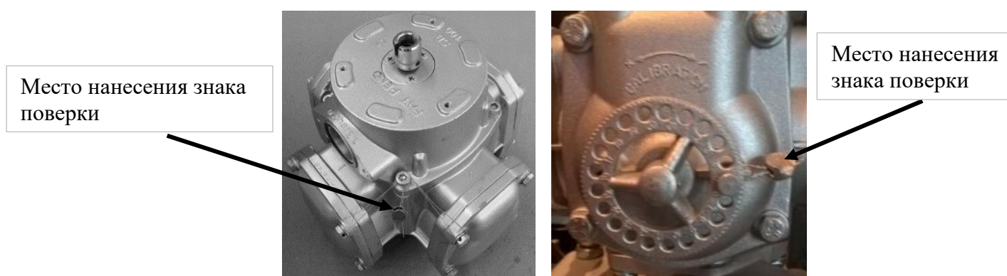
Рисунок 4 – Схемы пломбирования счётчика жидкости объёмного типа RSJ.
