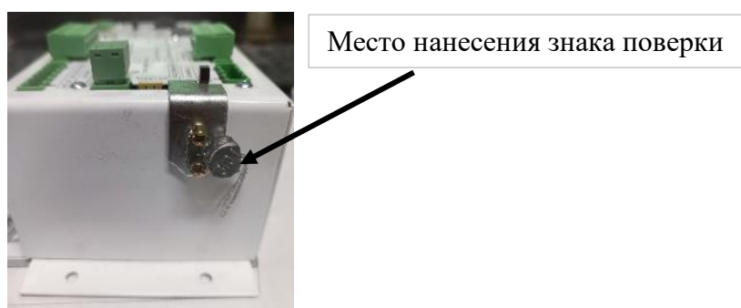
Рисунок 5 – Схема пломбирования контроллера управления (блока управления) «Эко-2».
