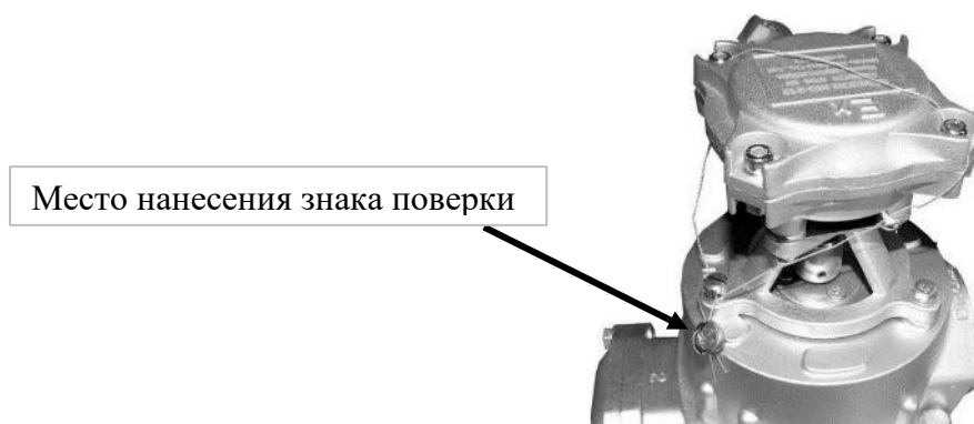
Рисунок 3 – Схема пломбирования генератора импульсов FBCGQ-3 производства фирмы «Zhejiang Datian Machine Co., LTD»
