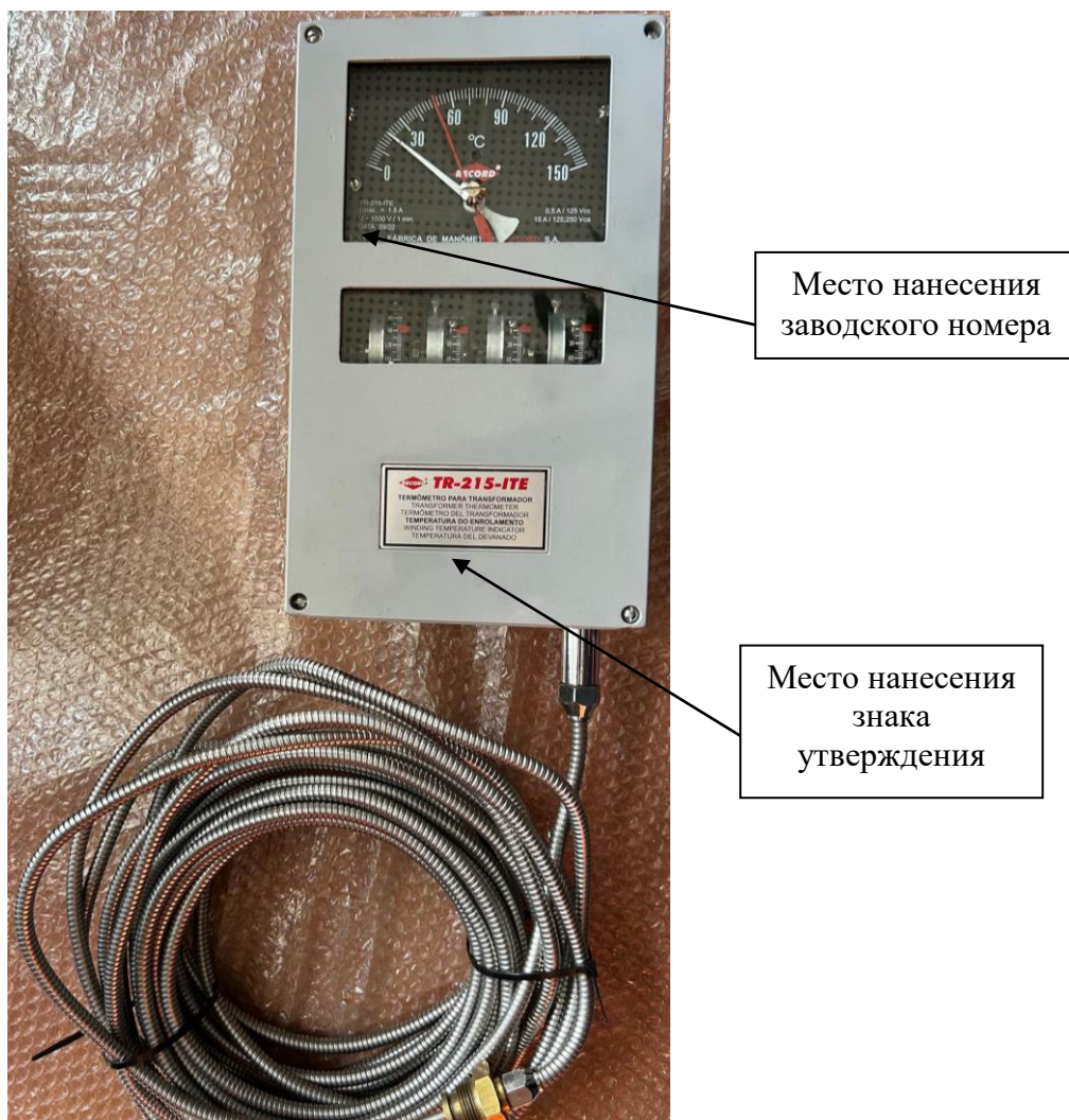
Рисунок 2 – Общий вид термометров модификации TR-215-ITE с указанием места нанесения знака утверждения типа, места нанесения заводского номера
