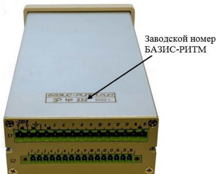
Рисунок 2 – Расположение заводского номера на корпусе БАЗИС-РИТМ
