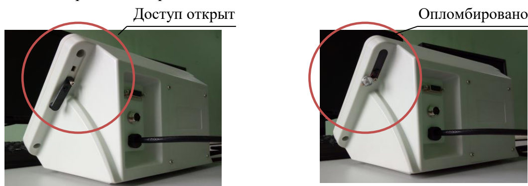
Рисунок 2 - Схема пломбировки от несанкционированного доступа
