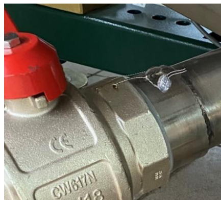
Рисунок 2 – Схемы пломбирования от несанкционированного доступа, обозначение мест нанесения знака поверки на регулируемые шкалы (при наличии) и сливные краны мерников установок поверочных УПМ
