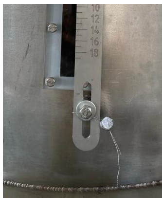
Рисунок 2 – Схемы пломбирования от несанкционированного доступа, обозначение мест нанесения знака поверки на регулируемые шкалы (при наличии) и сливные краны мерников установок поверочных УПМ
