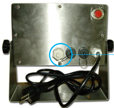
Рисунок 6 – Схема пломбировки от несанкционированного доступа весов с применением приборов весоизмерительных МИ ВДА/12ЯС, МИ ВЖА/12ЯС
