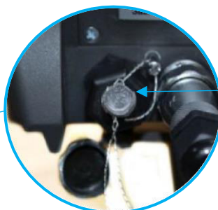
Рисунок 5 – Схема пломбировки от несанкционированного доступа весов с применением приборов весоизмерительных ТИТАН
