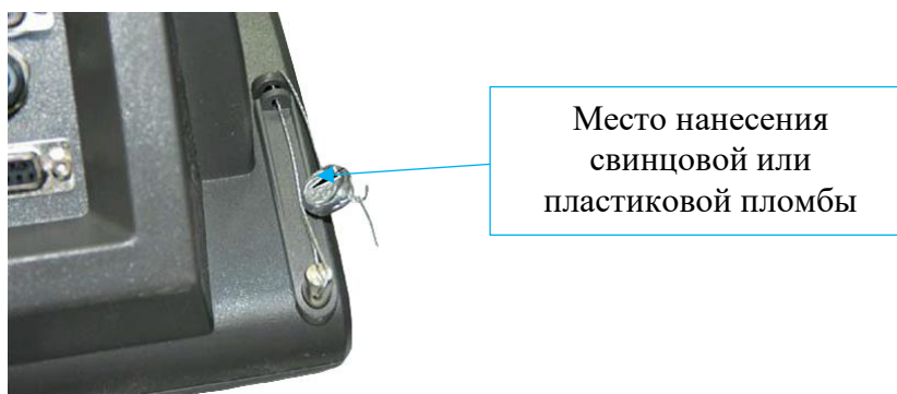
Рисунок 7 – Схема пломбировки от несанкционированного доступа весов с применением приборов весоизмерительных МИ ВДА/12Я, МИ ВЖА/12Я, МИ ВДА/12ЦС
