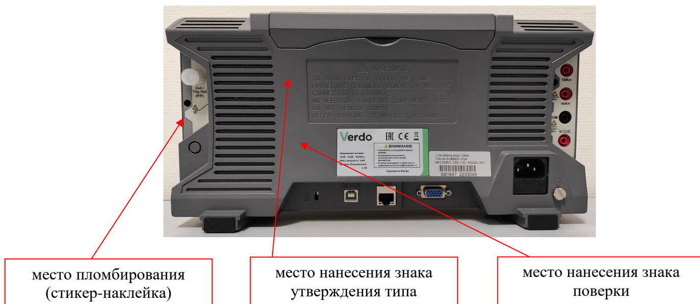
Рисунок 2 – Общий вид осциллографов, задняя панель
