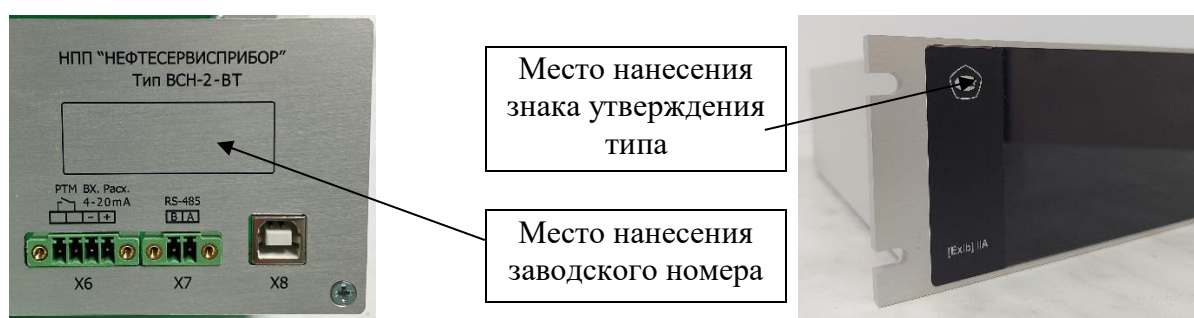
Рисунок 5а – Место нанесения знака утверждения типа и заводского номера на блок обработки в исполнении БОКИ
