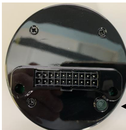
Рисунок 2 – Схема пломбировки от несанкционированного доступа
