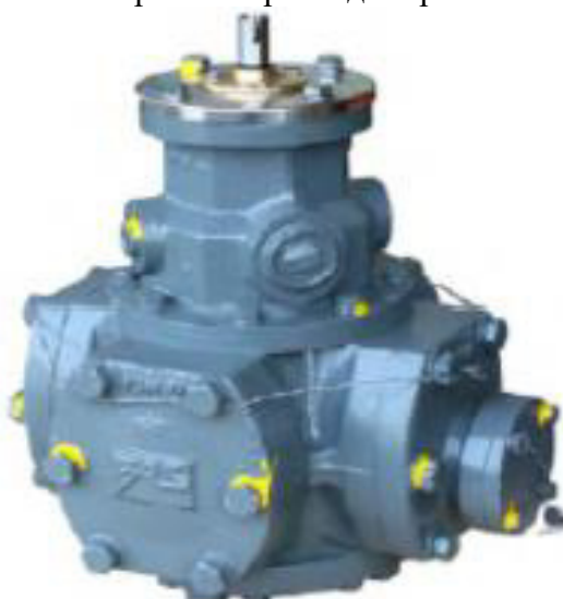
Рисунок 8 – Пломбирование расходомера объемного камерного (четырепоршневого)
