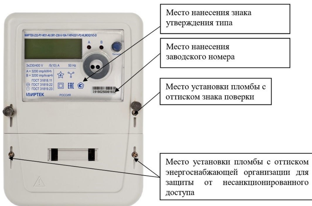
Рисунок 1 –Общий вид счетчика и схема пломбировки от несанкционированного доступа в корпусе типа W31
