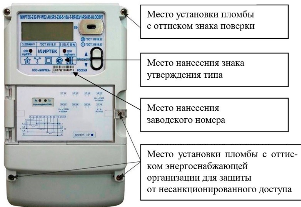
Рисунок 2 – Общий вид счетчика и схема пломбировки от несанкционированного доступа в корпусе типа W32
