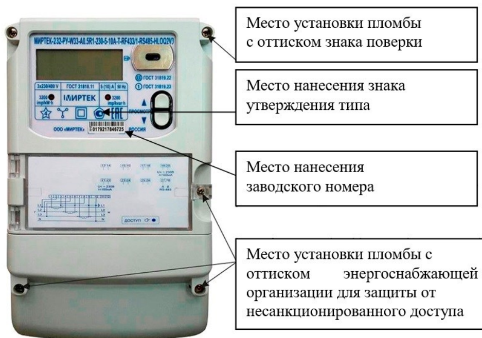
Рисунок 3 – Общий вид счетчика и схема пломбировки от несанкционированного доступа в корпусе типа W33
