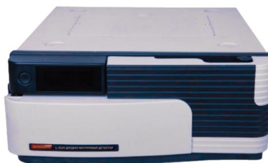
Рисунок 3 - Общий вид детектора спектрофотометрического с диодной матрицей ИнтерХром L-3520 ДМД
