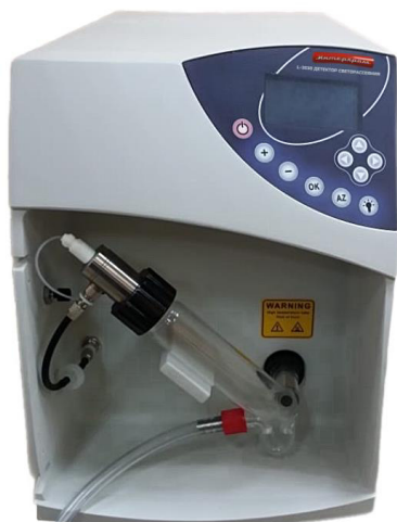
Рисунок 4 - Общий вид детектора светорас- сеяния ИнтерХром L-3530 ELSD
