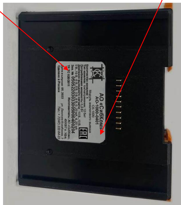
Рисунок 1 – Общий вид измерительного модуля программируемых логических контроллеров серии СК-1000 с указанием мест нанесения знака утверждения типа и заводского номера
