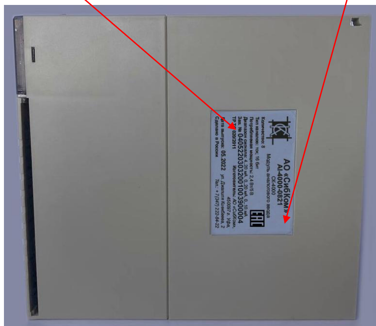
Рисунок 2 – Общий вид измерительного модуля программируемых логических контроллеров серии СК-4000 с указанием места нанесения знака утверждения типа и заводского номера
