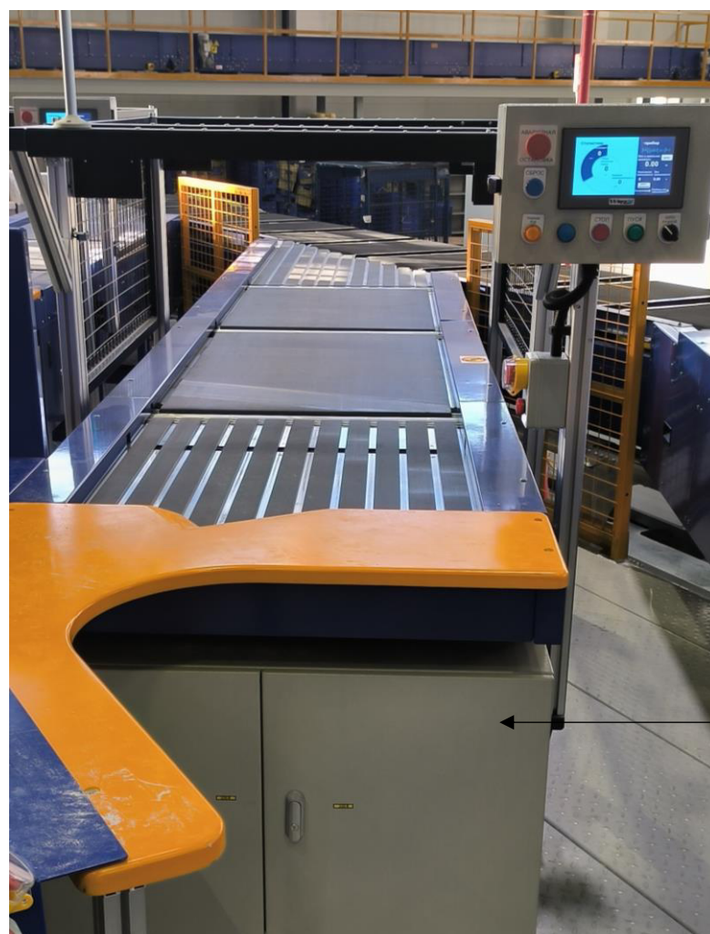
Рисунок 1 – Общий вид весов
