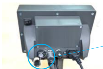
Рисунок 5 – Схема пломбировки от несанкционированного доступа весов с применением приборов весоизмерительных ТИТАН
