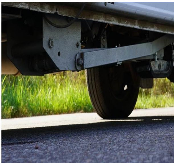
Рисунок 7 - Измеритель коэффициента сцепления покрытия автомобильных дорог ПКС
