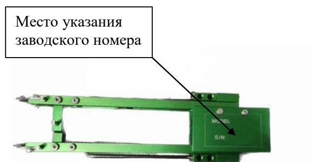
Рисунок 1 – Общий вид измерителей перемещений (деформаций) EX модификаций EX12.505, EX01505, EX02010, EX02505, EX02510, EX02512.5, EX05005, EX05010, EX05025, EX07525, EX10005, EX10010, EX10025, EX20010, EX20020
