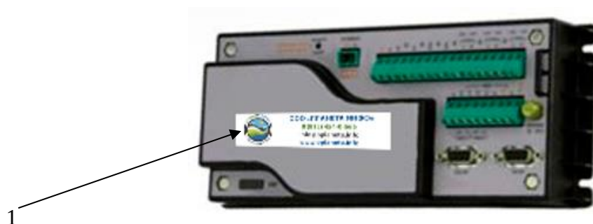
Рисунок 4 – Внешний вид регистратора Исп. 3 (OS-XXX) 1 - место нанесения заводского номера
