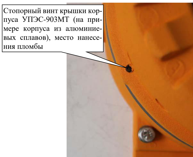
Рисунок 4 - Схема пломбировки газоанализаторов от несанкционированного доступа
