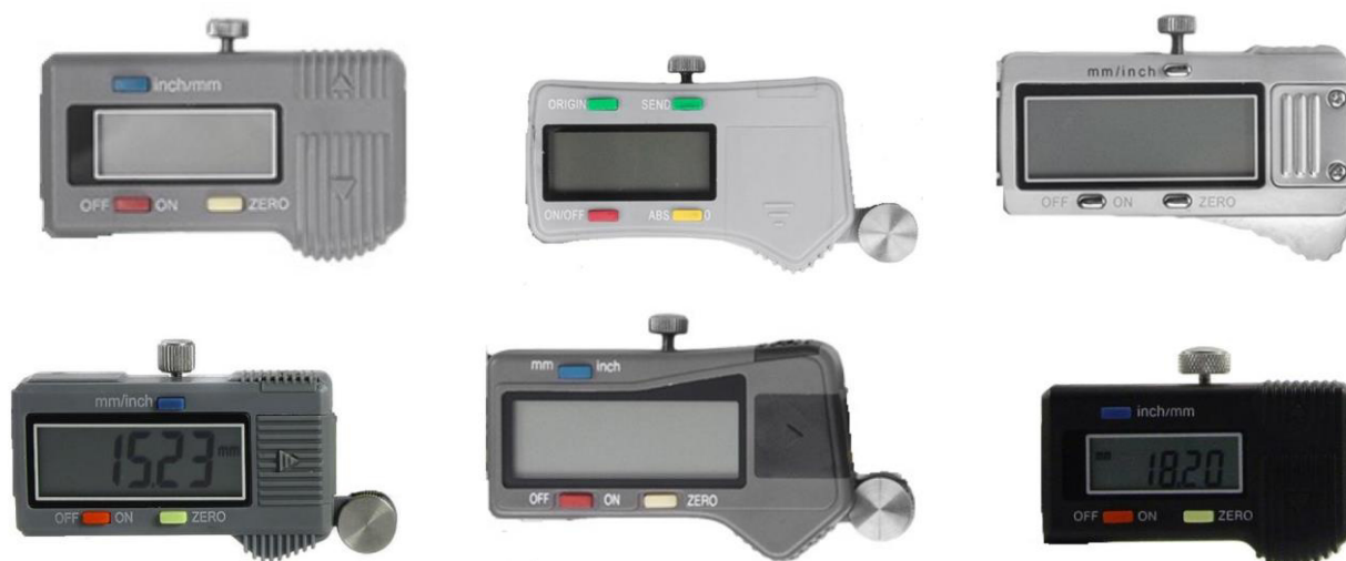
Рисунок 12 – Внешний вид корпуса цифрового отсчетного устройства штангенглубиномеров моделей ШГЦ и ИВПЦ
