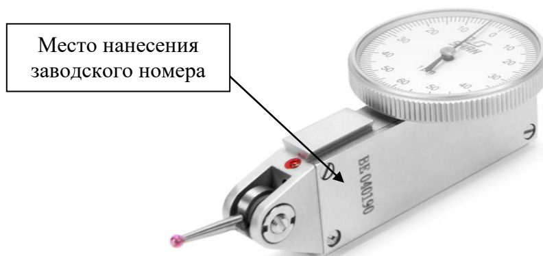
Рисунок 5 – Место нанесения заводского номера
