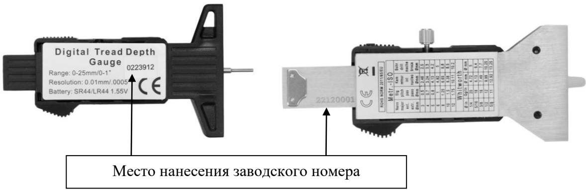
Рисунок 17 – Места нанесения заводского номера
