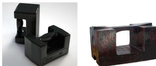
Рисунок 2 – Общий вид гирь в форме параллелепипеда с рукояткой и посадочными местами для штабелирования
