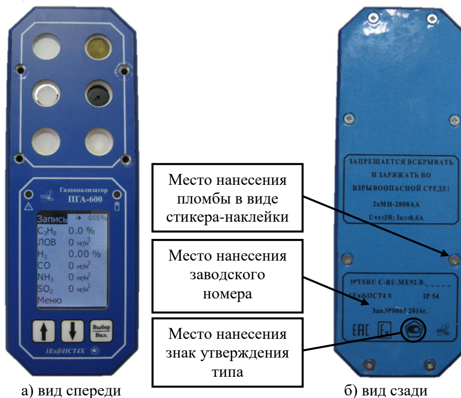
Рисунок 1 – Внешний вид газоанализаторов ПГА-600 (синем корпусе)
