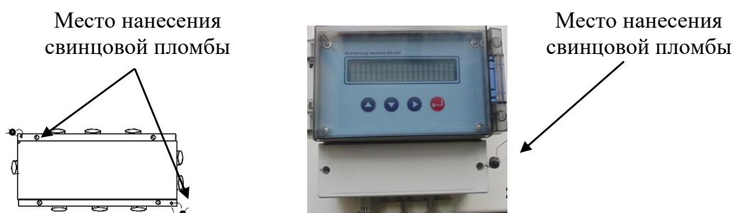
Рисунок 3 – Схема пломбировки корпуса соединительной коробки (слева) и КВ-006 (справа)
