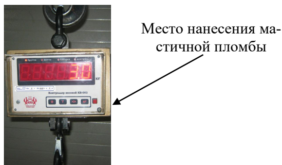
Рисунок 2 – Схема пломбировки весов
