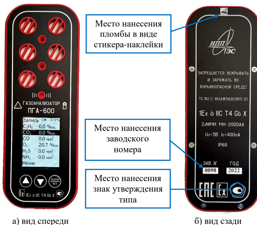
Рисунок 2 – Внешний вид газоанализаторов ПГА-600 (черно-красном корпусе)
