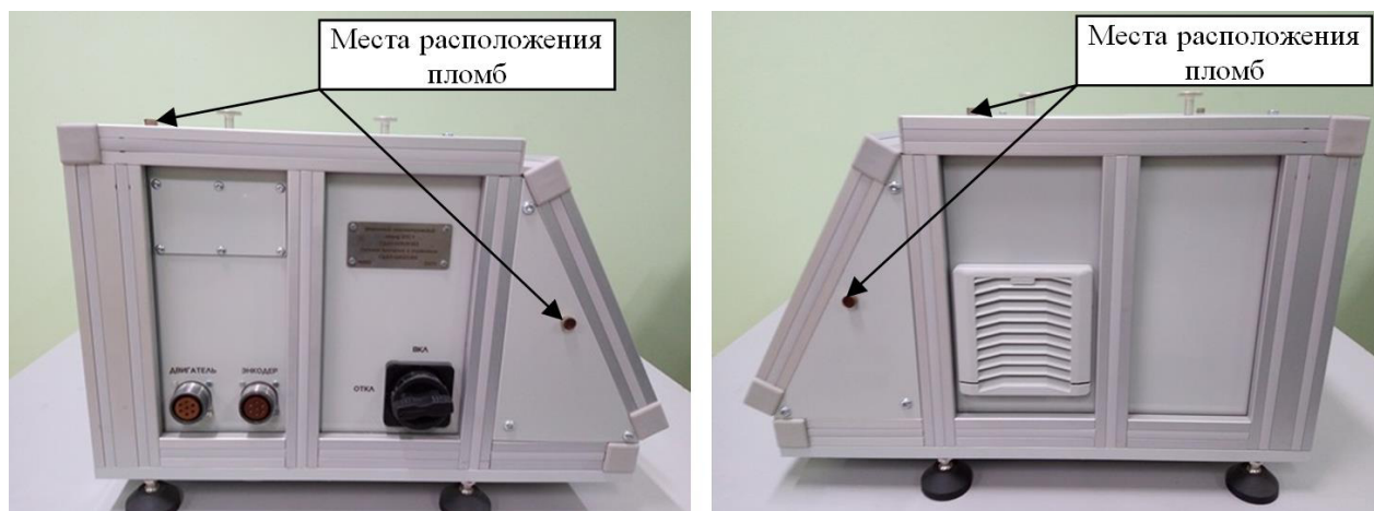
Рисунок 2 - Схема пломбирования стенда от несанкционированного доступа
