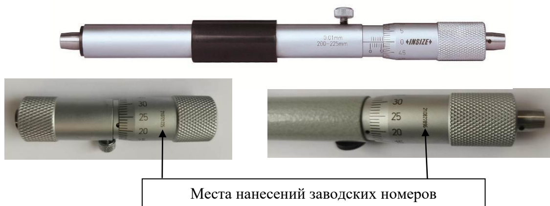
Рисунок 5 – Общий вид нутромеров модели 3229 с указанием мест нанесений заводских номеров
