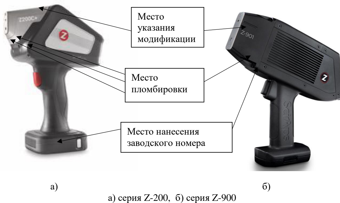
Рисунок 1 - Общий вид спектрометров с указанием места пломбировки, места нанесения заводского номера
