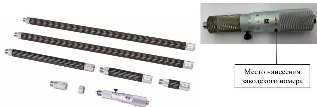
Рисунок 7 – Общий вид нутромеров модели 3634 с указанием места нанесения заводского номера
