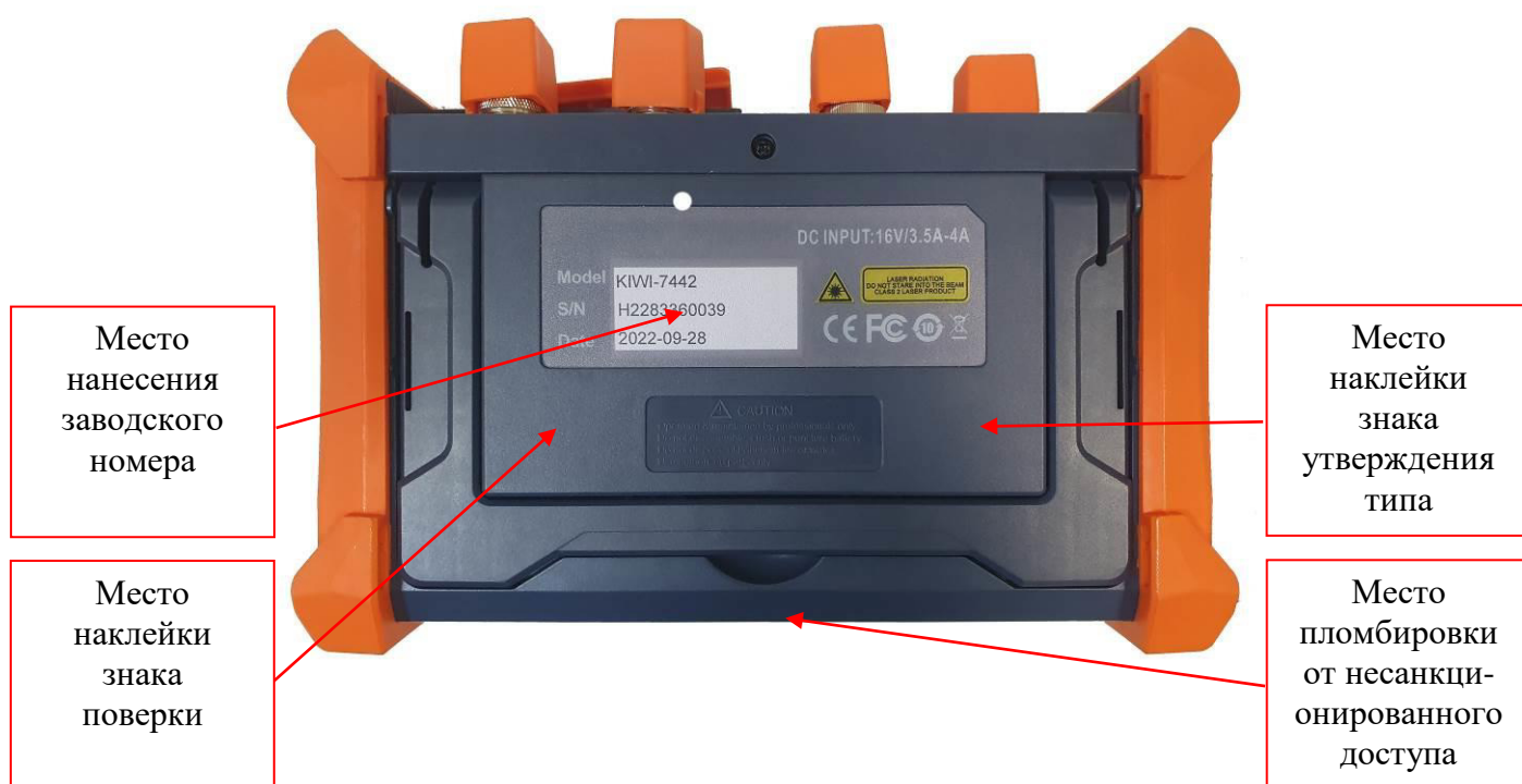
Рисунок 3 – Место нанесения заводского номера, место пломбировки от несанкционированного доступа, место наклейки знака утверждения типа рефлектметров оптических KIWI-7400
