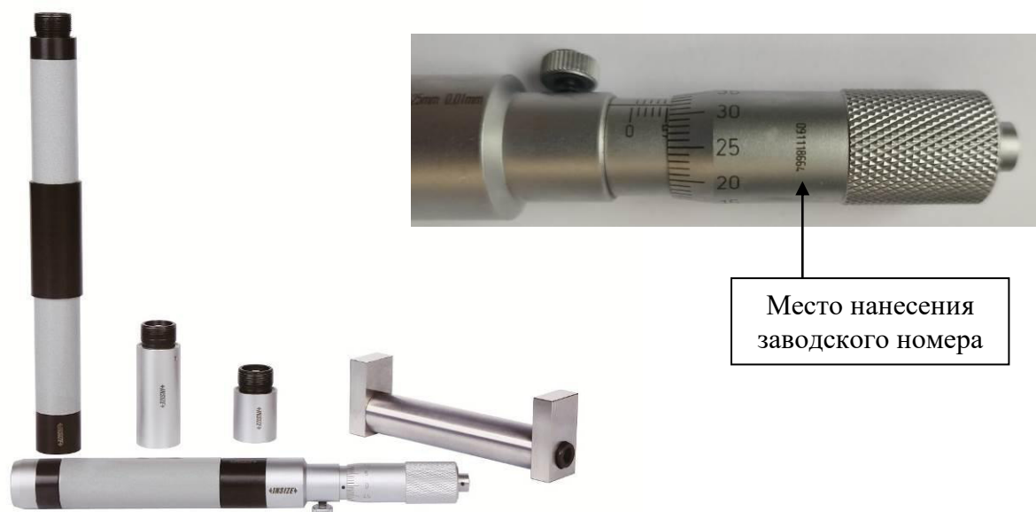
Рисунок 4 – Общий вид нутромеров модели 3225 с указанием места нанесения заводского номера
