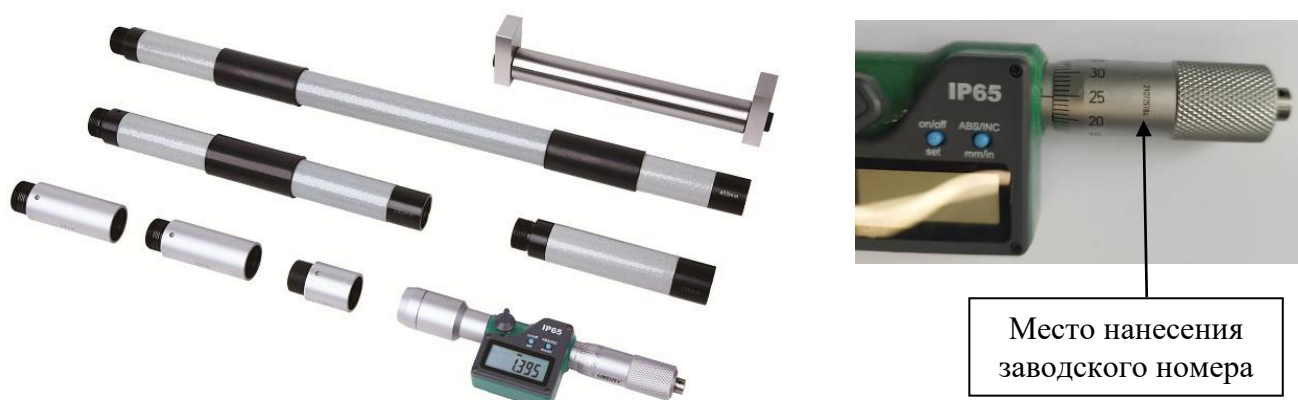
Рисунок 6 – Общий вид нутромеров модели 3521 с указанием места нанесения заводского номера
