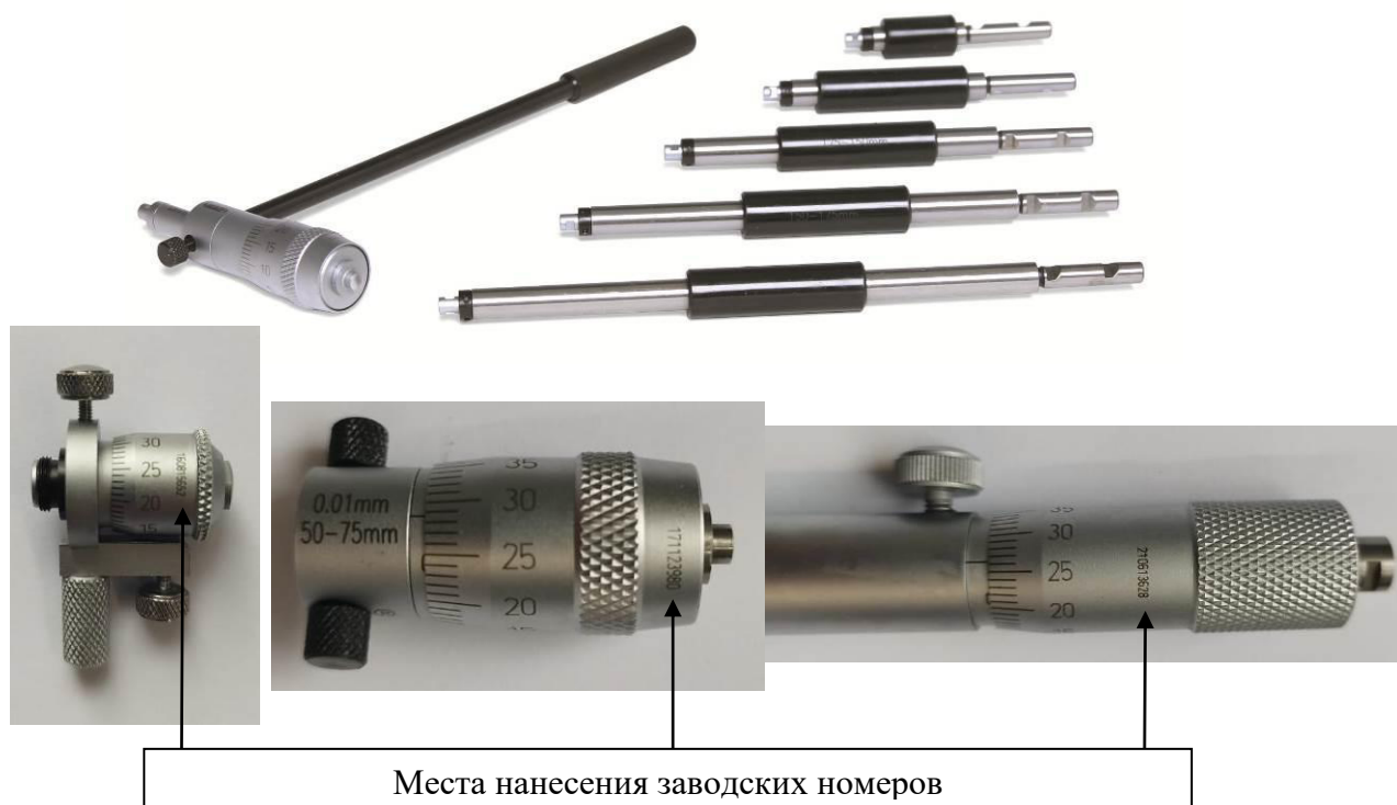
Рисунок 1 – Общий вид нутромеров модели 3221 с указанием мест нанесений заводских номеров
