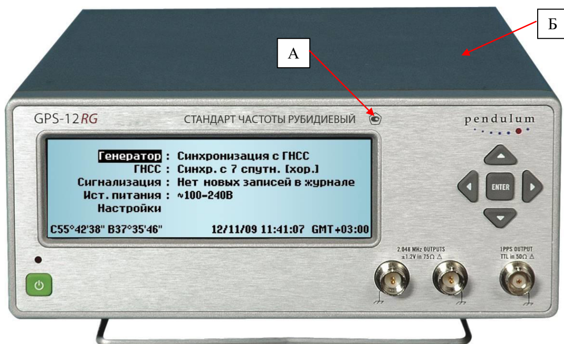
Рисунок 1 – Внешний вид стандартов частоты, схема нанесения знака утверждения типа (А) и схема нанесения знака поверки (Б); вариант исполнения лицевой панели с органами управления квадратной и треугольной формы (вариант 1)
