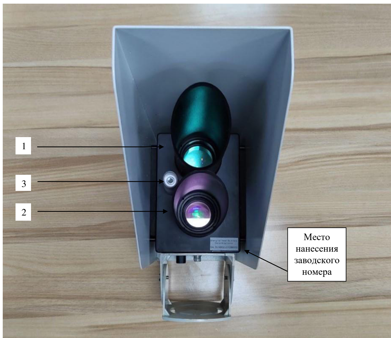
Рисунок 1 – Общий вид датчиков NIR51 1 – излучатель, 2 – приемник, 3 - пирометр
