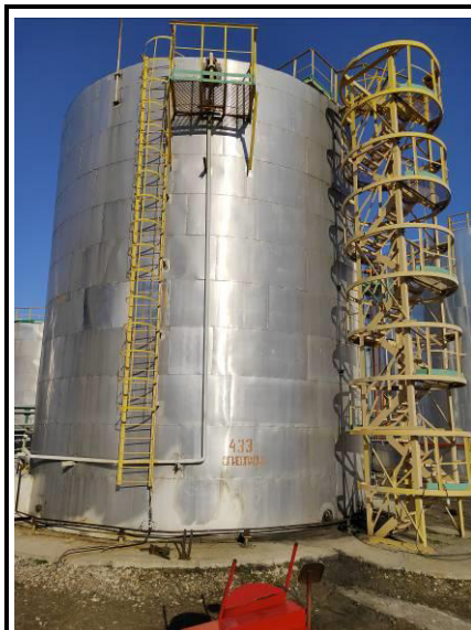
Рисунок 7 – Общий вид резервуара РВС-1000 (№433) с замерным люком
