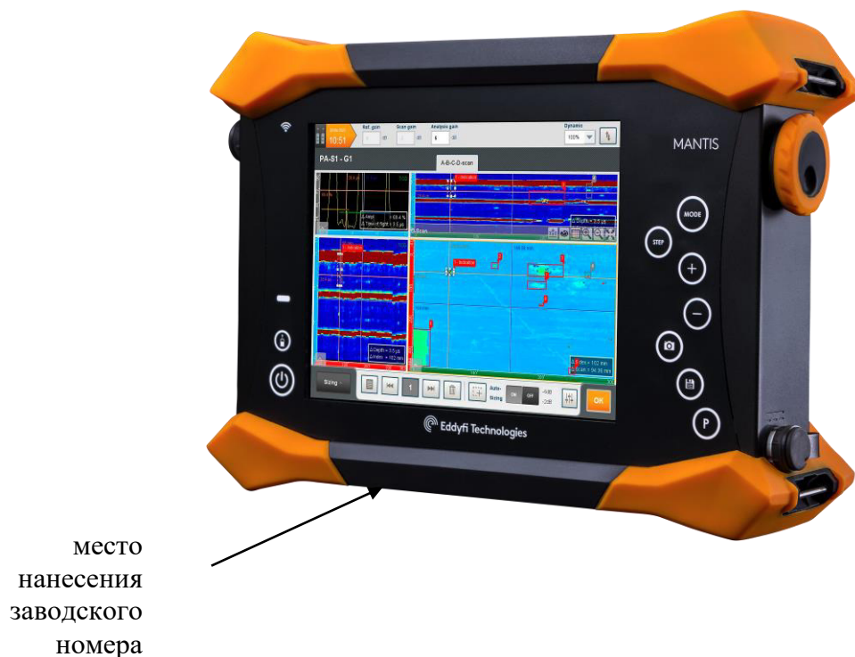
Рисунок 1 - Общий вид дефектоскопов ультразвуковые MANTIS
