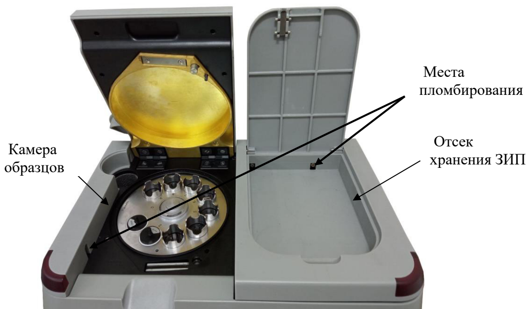
Рисунок 2б – Места установки пломб анализатора на внутренней панели камеры образцов и отсека хранения ЗИП
