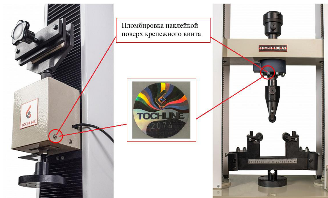
Рисунок 7 – Схема пломбировки машин от несанкционированного доступа
