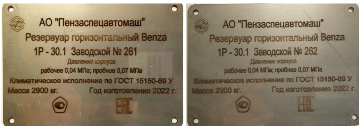
Рисунок 1 – Маркировочные таблички резервуаров 1Р-30.1
