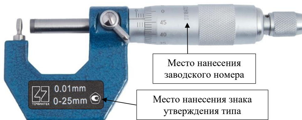
Рисунок 14 – Общий вид микрометров типа МТ с отсчетом показаний по шкалам стебля и барабана с указанием мест нанесений заводского номера и знака утверждения типа
