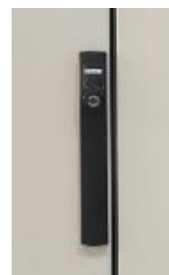
Рисунок 6 – Замок шкафа сервера
