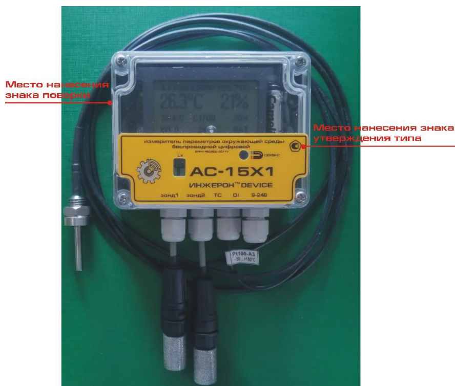
Рисунок 5 – Общий вид средства измерений и обозначение мест нанесения знака поверки и знака утверждения типа для модификаций AC -15X1
