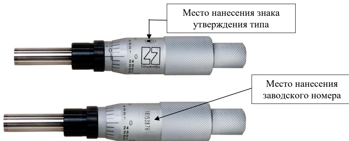
Рисунок 20 – Общий вид микрометров типа МГ с отсчетом показаний по шкалам стебля и барабана с указанием мест нанесений заводского номера и знака утверждения типа
