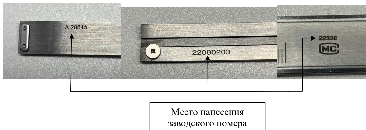
Рисунок 8 – Места нанесения заводских номеров
