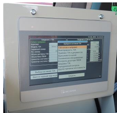
Рисунок 5 – Панель оператора сенсорная (ПОС-10)
