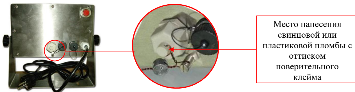
Рисунок 4 - Схема пломбировки весов с применением весоизмерительных приборов МИ ВДА/12ЯС, МИ ВЖА/12ЯС от несанкционированного доступа и место нанесения знака поверки
