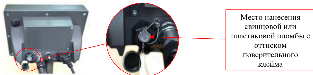
Рисунок 6 – Схема пломбировки весов с применением весоизмерительных приборов ТИТАН от несанкционированного доступа и место нанесения знака поверки
