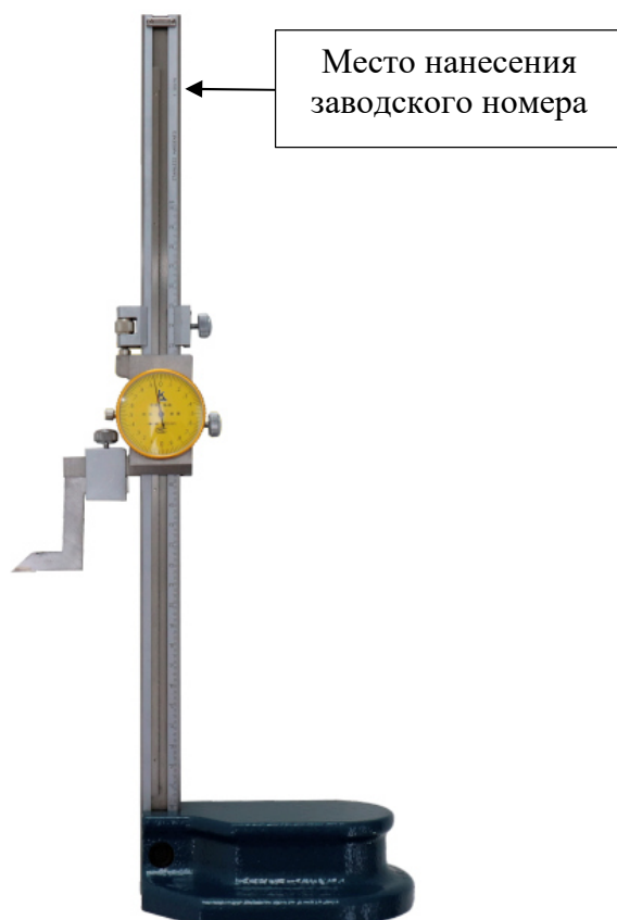
Рисунок 2 – Общий вид штангенрейсмасов модели ШРК с указанием места нанесения заводского номера
