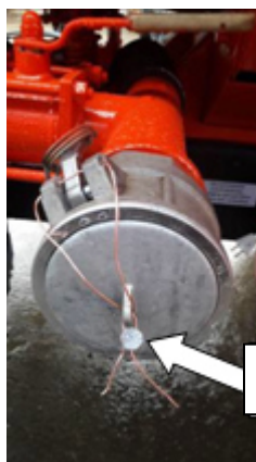
Рисунок 5 – Пломбировка трубопровода слива-налива
