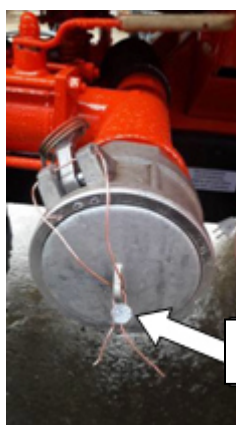
Рисунок 4 – Пломбировка трубопровода слива-налива
