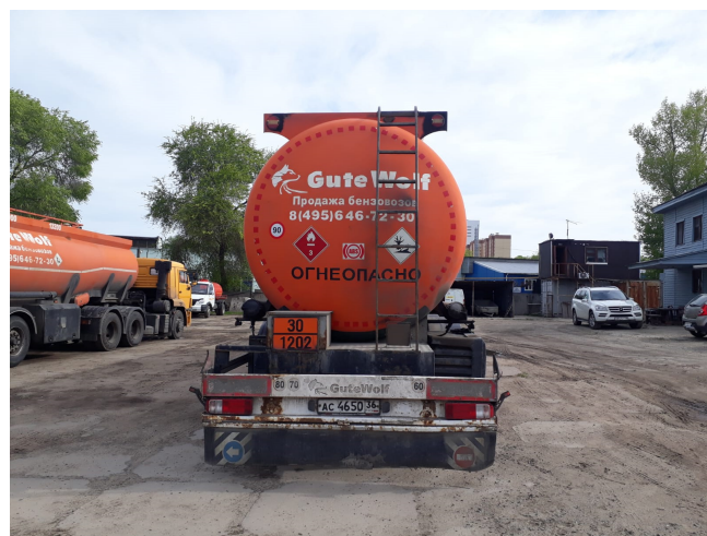
Рисунок 3 – Полуприцеп-цистерна для жидких нефтепродуктов GUTE WOLF DMD заводской номер NP9DMD012DA259078. Вид сзади.
