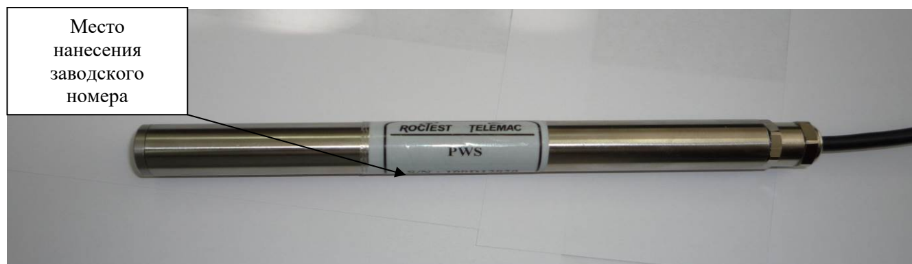
Рисунок 2 – Общий вид преобразователя давления вибрационного струнного PWS
