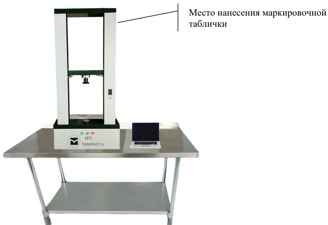
Рисунок 4 - Общий вид машин модификации ИР 52YH-PS с верхним пределом диапазона измерения силы от 0,1 до 100 кН вкл.
