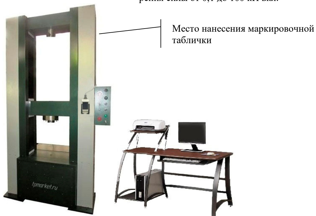
Рисунок 5 - Общий вид машин модификации ИР 52Y-PS с верхним пределом диапазона измерения силы от 200 до 600 кН вкл.
