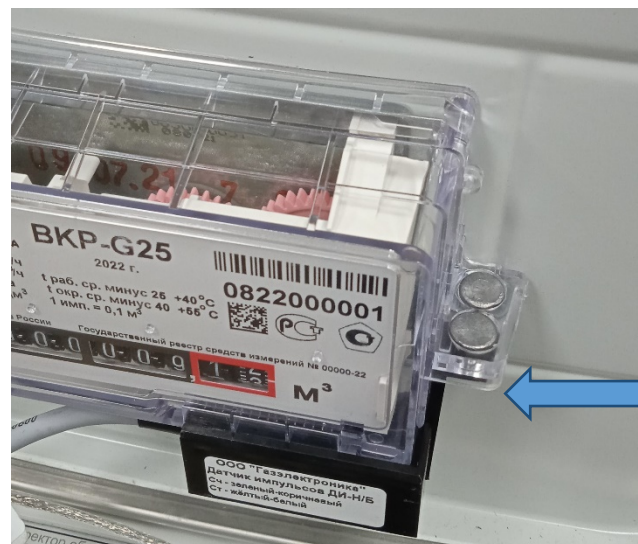
Рисунок 5 – Схема пломбировки от несанкционированного доступа места присоединения датчика импульсов, обозначение места нанесения знака поверки счетчика газа
