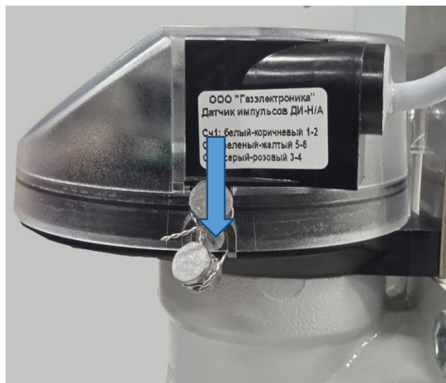
Рисунок 5 – Схема пломбировки от несанкционированного доступа места присоединения датчика импульсов, обозначение места нанесения знака поверки счетчика газа
