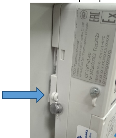
Монтаж термопреобразователя сопротивления Pt500 (500П) на корпусе счетчика Рисунок 4 – Схема пломбировки от несанкционированного доступа места присоединения преобразователя температуры, обозначение места нанесения знака поверки
