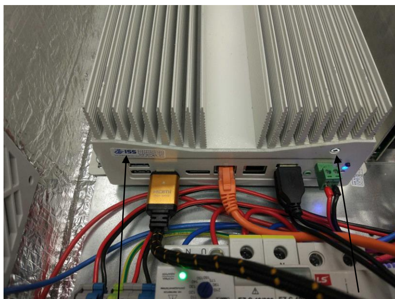
Рисунок 2 - Место пломбирования комплексов
