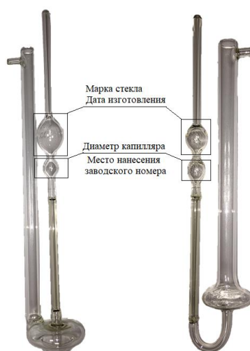
Рисунок 3 – Общий вид вискозиметров стеклянных капиллярных модификации ВПЖ (слева направо ВПЖ-2, ВПЖ-4)
