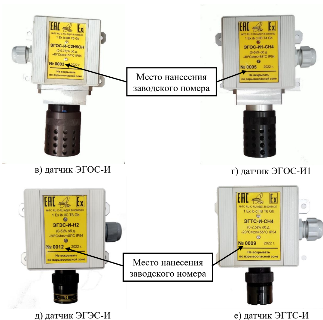
Рисунок 1 – Общий вид блоков газоанализаторов с указанием мест пломбировки, мест нанесения знака утверждения типа и заводского номера
