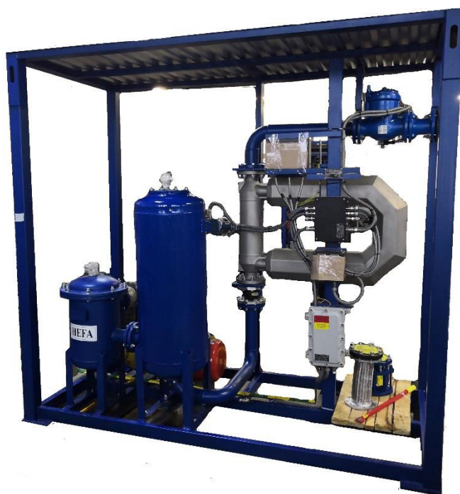
Рисунок 5 – АТНК-МХХХС. (Исполнение с массомером СКАТ)
