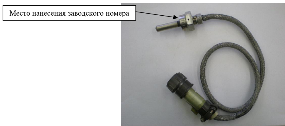
Рисунок 2 – Общий вид ТП и место нанесения заводского номера
