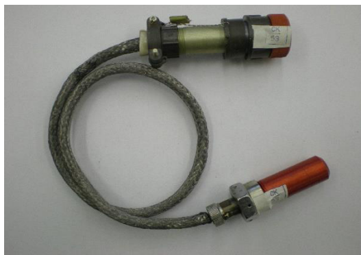
Рисунок 1 – Общий вид ТП в опломбированном виде с заглушкой на рабочей части и крышкой на разъеме
