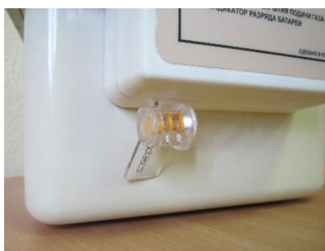
Рисунок 4 – Пломбирование крышки батарейного отсека
